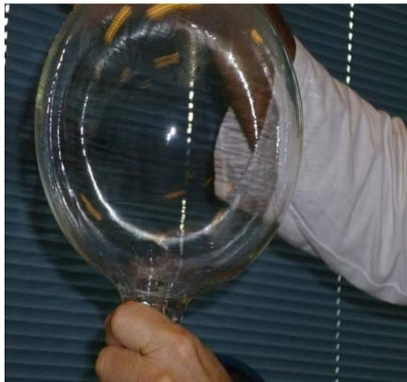
Pour éviter que les ballons se déforment le souffleur de verre met les ballons au four entre 200°C et 300°C.
