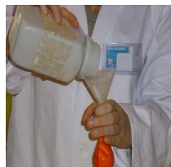
Avec la réaction chimique entre le vinaigre et le bicarbonate cela crée un gaz nommé dioxyde de carbone qui fait gonfler le ballon
