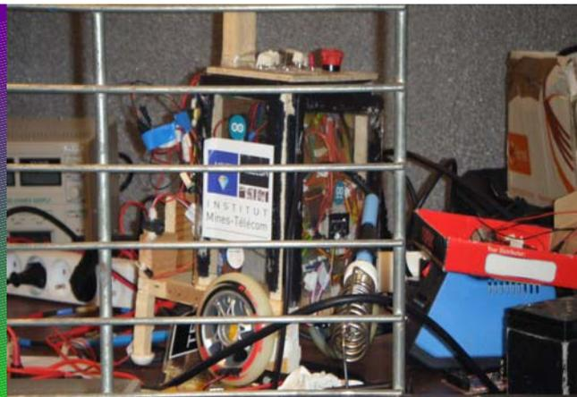
Voici Krabi crée par Maxime de télécom bretagne. Il est constitué de ferraille, d'un code, une carte STM, un moteur et une carte capteur arrière.
